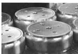
家庭に送電する際の変電所で使われる部品に部分メッキを施す
